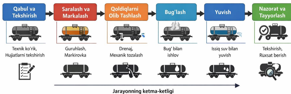
1-rasm. Vagon-sisternalarni bug'lab yuvish texnologik sxemasi
